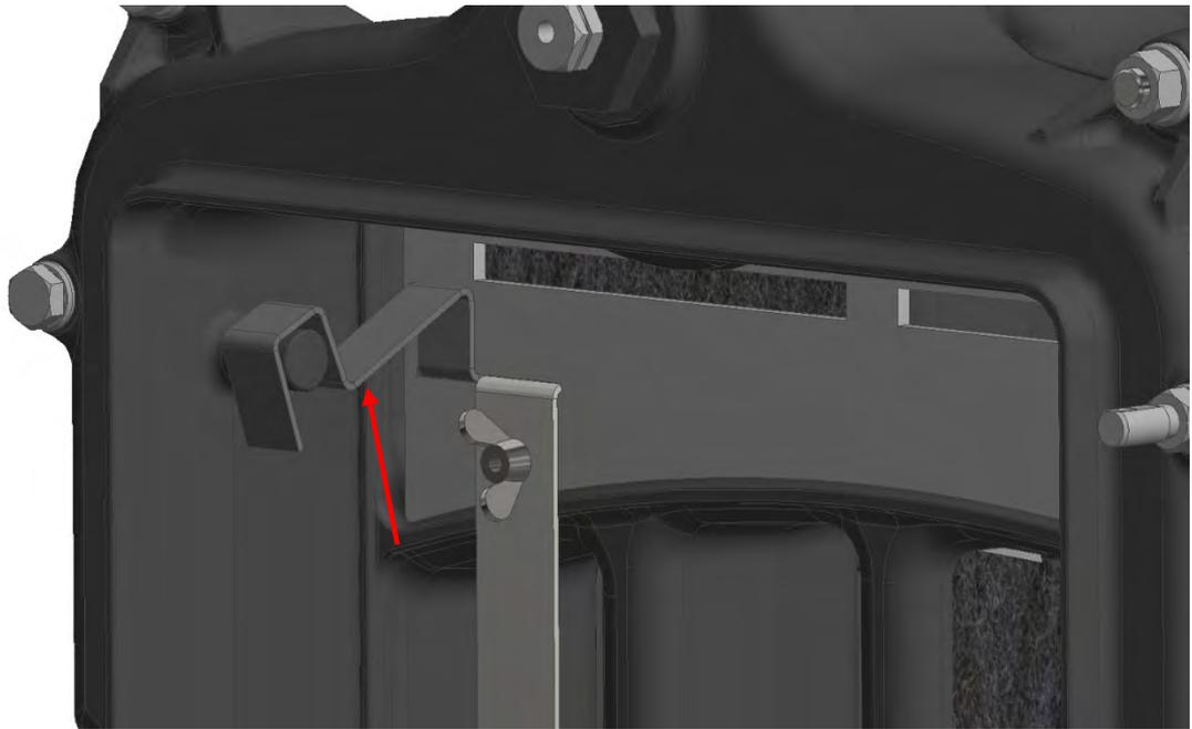
Anschließend entnehmen Sie die Stahlwolleballe aus den Rauchgaskanälen
