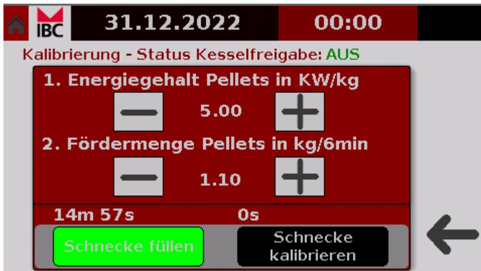
Die Förderschnecke wird nun 15min. gefüllt.
