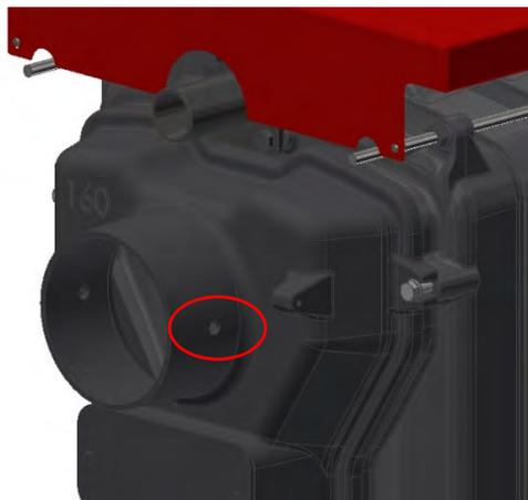
Verlegen Sie das Kabel des Abgastemperaturfühlers durch die Kabeldurchführung am Verkleidungsdeckel bis in das Regelungsgehäuse.
