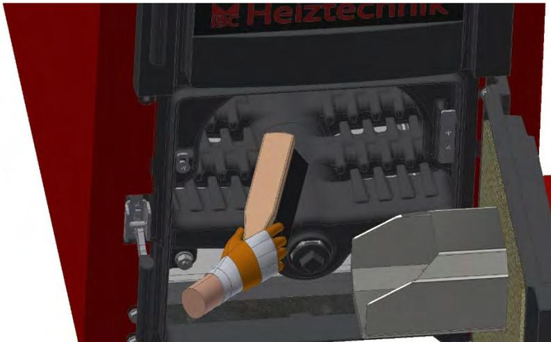
Abgekühlte Asche mit einem Kehrbesen oder einer Drahtbesen entfernen.
